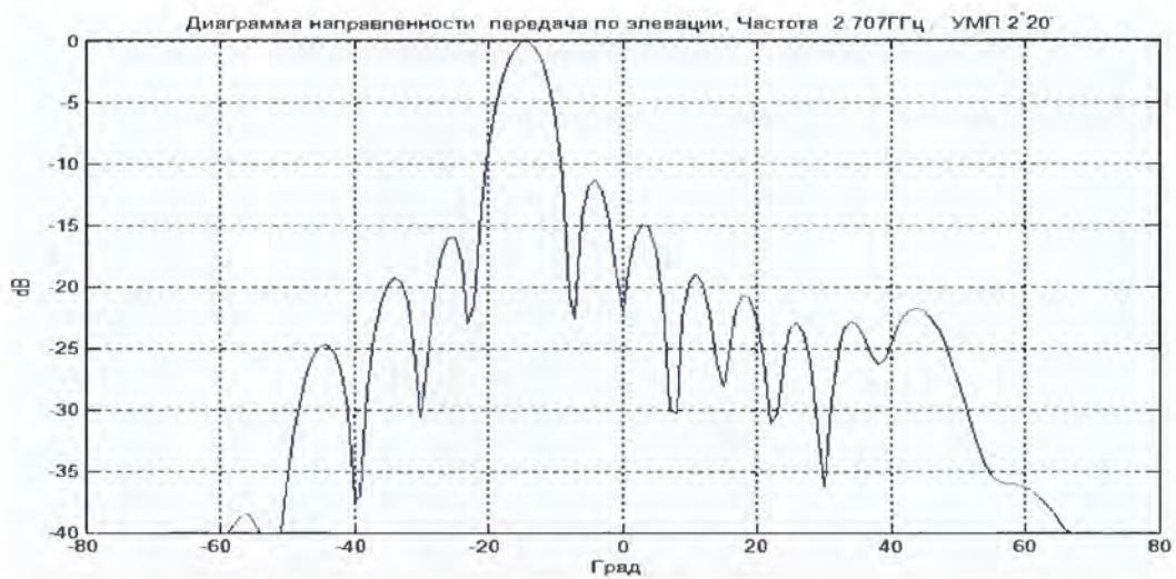
Рис. 40. Сечение ДН по элевации,  $\phi = 0$
