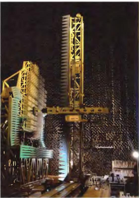
Рис. 2. Измерения в ближней зоне
