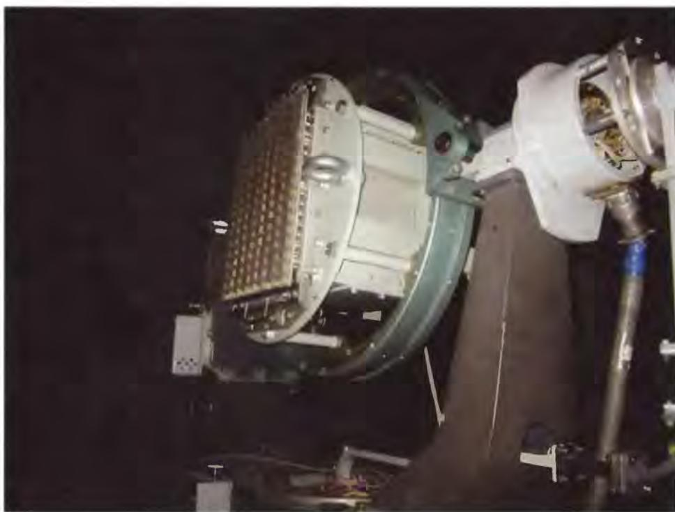
Рис. 5. Внешний вид испытуемой АФАР
