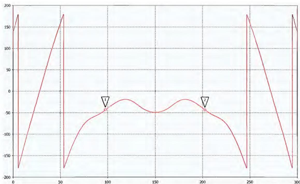
Рис. 5. Фазовое распределение вдоль решетки на расстоянии  $3\lambda$  от вибраторов
