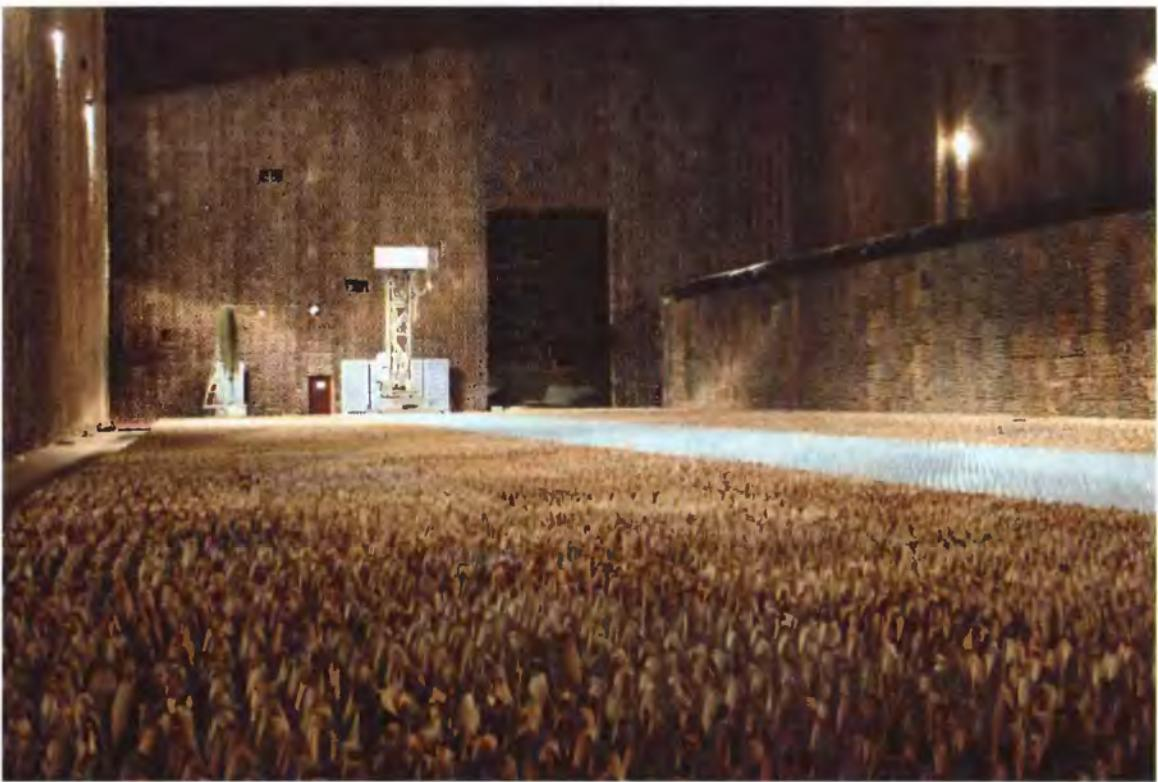
Рис. 1. Большая безэховая камера в ПАО «Радиофизика»
