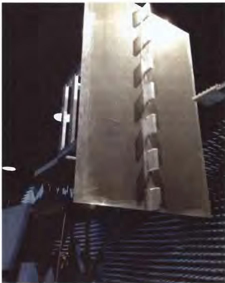
Рис. 29. Семиэлементный эталон на поворотном столе
