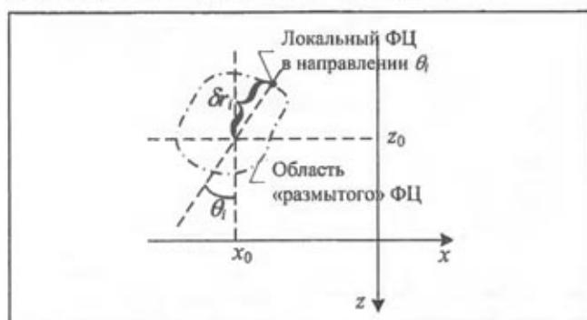
Рис. 4. Построение области размытого фазового центра
