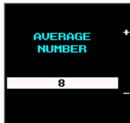
Изменения количества усреднений сигнала при его вводе. Включение – выключения режима усреднения сигналов производится кнопкой **Average** на передней панели прибора.
