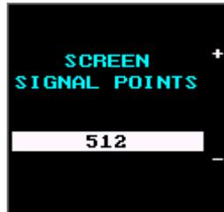
Выбор количества точек в регистрируемом сигнале для вывода на экран. Чем меньше точек, тем выше частота обновления экрана. Возможен выбор 16, 32, 64, 128, 256 и 512 точек.
