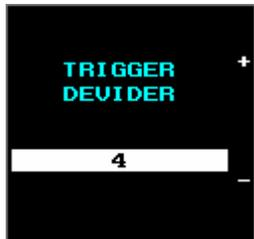
Выбор коэффициента делителя частоты внешнего запуска прибора. Возможен выбор из следующих значений: OFF, 2, 4, 8, 16, 32, 64, 128 и 256.
