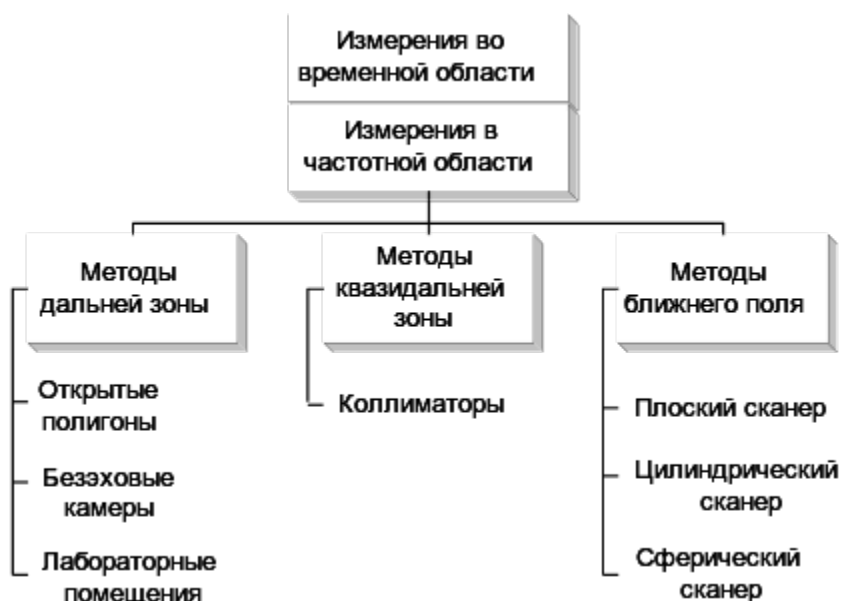
Рис.1. Классификация методов измерения антенн и типов АИВК.
